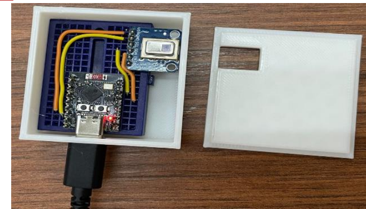
Fig 3. Prototipo encapsulado abierto del sistema de monitoreo
